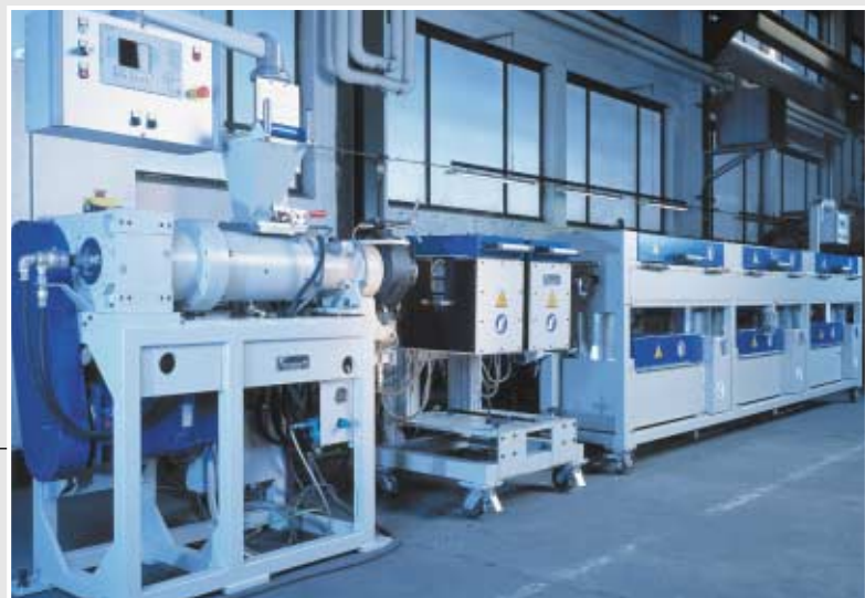
Anlage zur Herstellung von Silikonschläuchen
