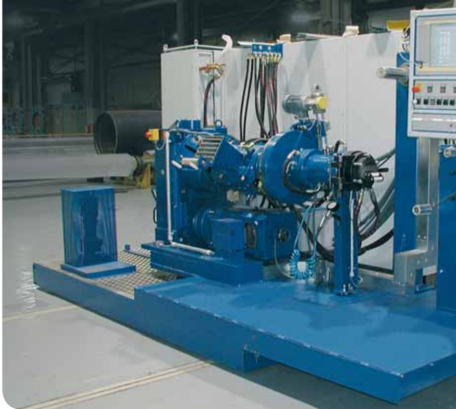
Streifenwickel-Anlage mit GE 90 KS x 12D
