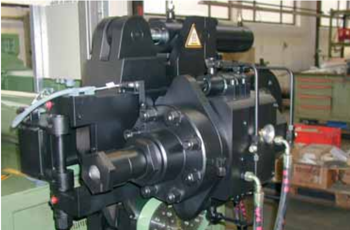
Mit hydraulischem Klammerverschluss und hydraulischer Leitstück-Ausdrückeinrichtung
